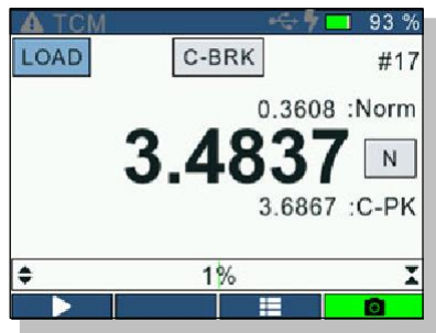
实时试验结果显示界面，显示试验次数、通过/失败显示、单位和模式显示等。
